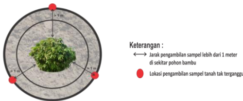
Gambar 4 : Sketsa Pengambilan Sampel Tanah Tak Terganggu.
