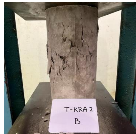
Gambar 2. Pengujian Kuat Tekan Beton
