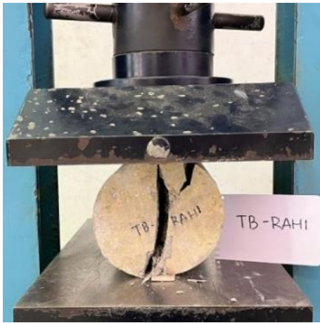
Gambar 4. Pengujian Kuat Tarik Belah Beton
