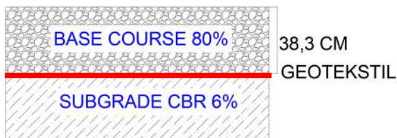
Gambar 7 Tebal Perkerasan Metode Giroud-Han Menggunakan Perkuatan Geotekstil
